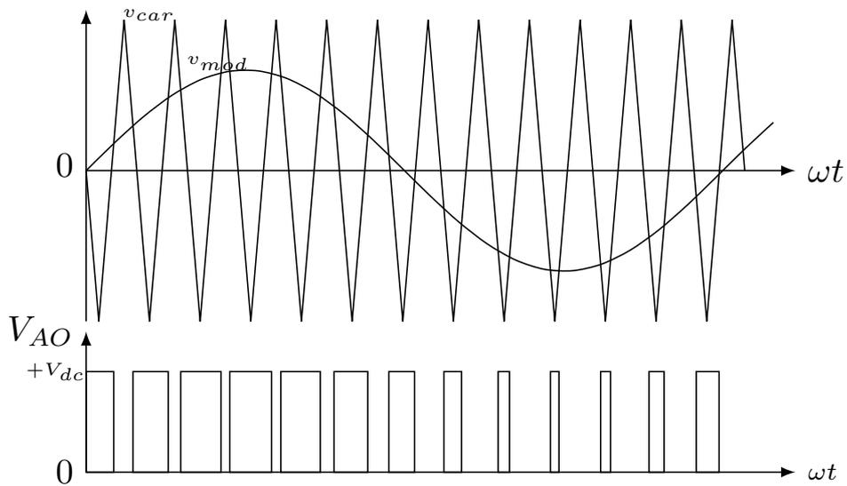
**Figure 1.3:** Sinusoidal PWM scheme.
